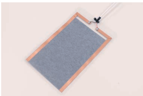
▲「TAIYO SHEET_RH」和紙とカーボンを複合した新素材。通電により面全体が均一に発熱し、主に融雪設備として活用されます。
